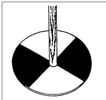
Figure 1. Secchi disk.
